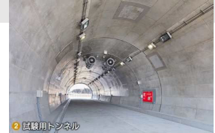
2 試験用トンネル 背面空洞を有するトンネル実験施設の例 （福島ロボットテストフィールドホーム ページより引用）
