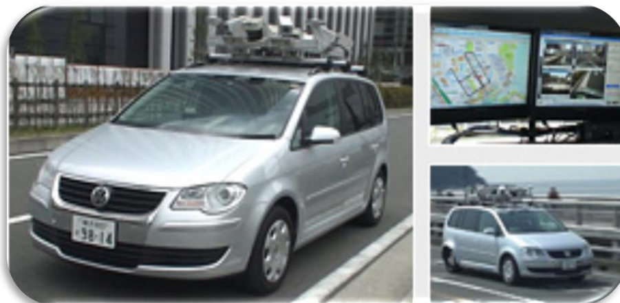
地上移動体搭載型レーザースキャナー（車載型の例）
