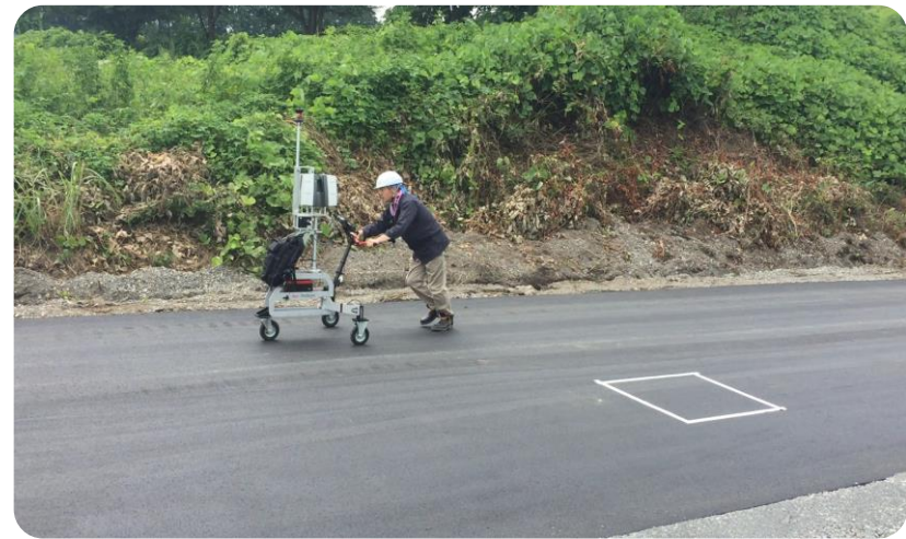
地上移動体搭載型レーザースキャナー（手押車型の例）
