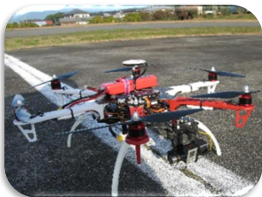
無人航空機を用いた 空中写真測量
