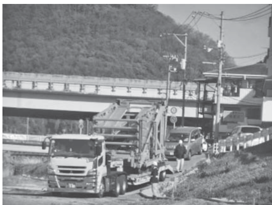
(a)モバイルブリッジの運搬
