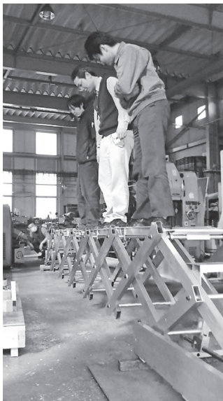
写真-5 載荷試験状況 (大人3名で載荷)
