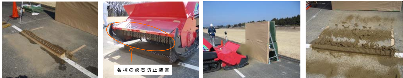
(a) 模擬小石と砂台 (セラミック球 φ12×60個) (b) ハンドガイド式草刈機の作業機 各種の飛石防止装置 (c) 飛石再現実験 (最高回転にて) (d) 実験後の砂台 (60個全てが飛散)
