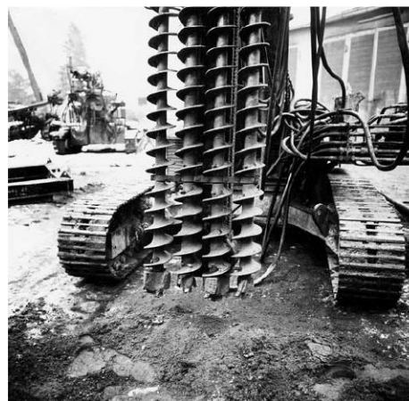
写真-3 米国におけるスラリー系施工機械の紹介例
