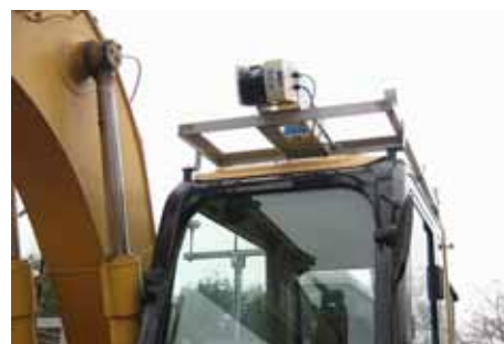
写真-2 レーザスキャナー・システム
