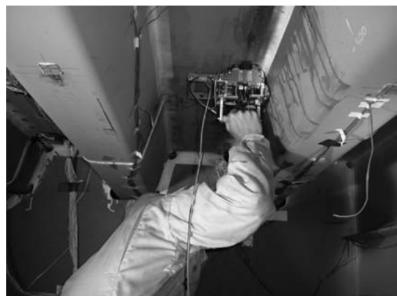
写真四 タイヤ式鋼床版探傷装置 (財)首都高速道路技術センターと共同開発)
