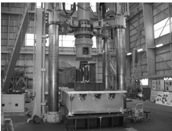
写真三 大型疲労試験機 (首都高速道路株式会社より受託)
