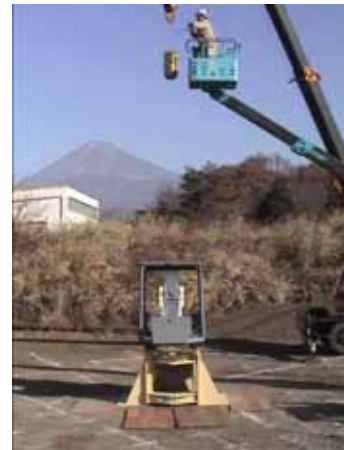
写真 - 1 FOPS (レベル) の試験状況
