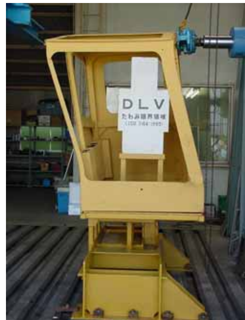
写真 - 2 ROPS 試験状況
