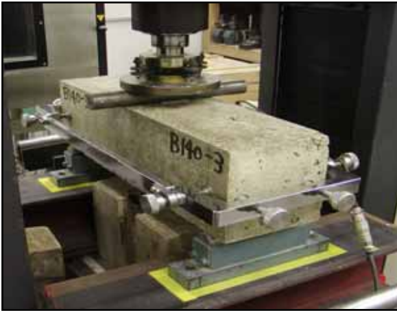
写真-2 破壊エネルギー試験状況
