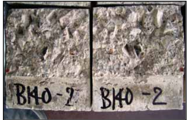
写真-3 供試体の破壊断面状況
