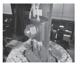
図─7 スタッドボルト溶接鋼板の引張疲労試験
