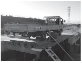
写真-2 実トラック載荷試験の状況
