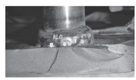
図一9 破断面
