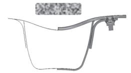
図―2 Uリブの内側に車輪が載荷された場合のUリブの変形
