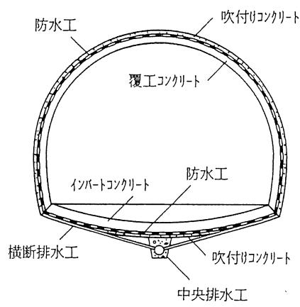
図-1 排水型トンネル<sup>2)</sup>
