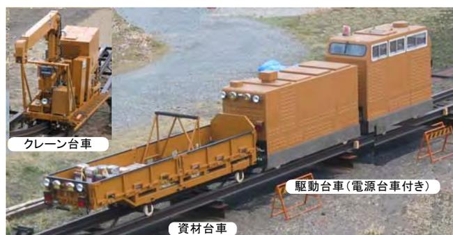
写真-3 第2号試作機の各台車
