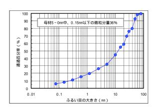
図-3 現地発生材(掘削ズリ)の粒度分布
