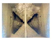
写真-3 CSGの混合機の一例と混合機へのCSG付着状況
