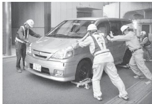
写真一2 車両移動用ジャッキの外観と移動作業状況
