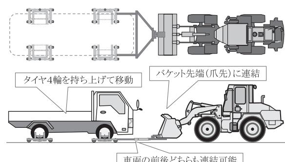
図一2 全輪にジャッキ付ドーリーを配置する2次試作機
