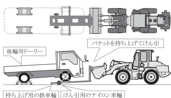
図一1 テコの原理で前輪を持ち上げる1次試作機
