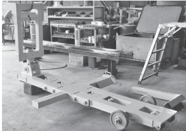
写真-8 1次試作機の組立状況（メインフレーム）
