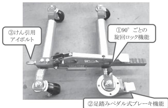
写真一6 追加改良後の車両移動用ジャッキ
