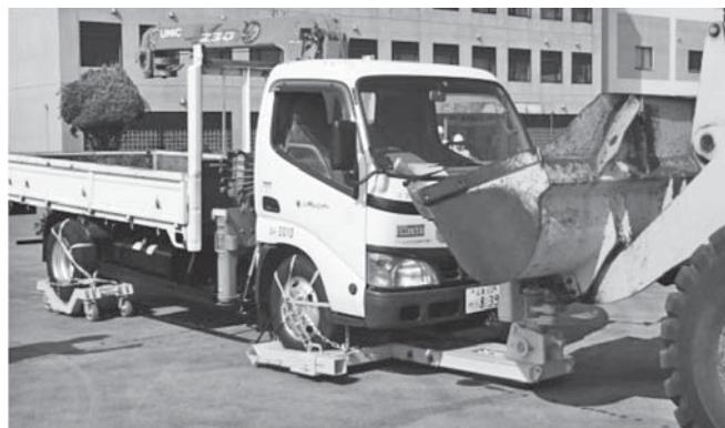
写真-9 1次試作機によるけん引作業状況
