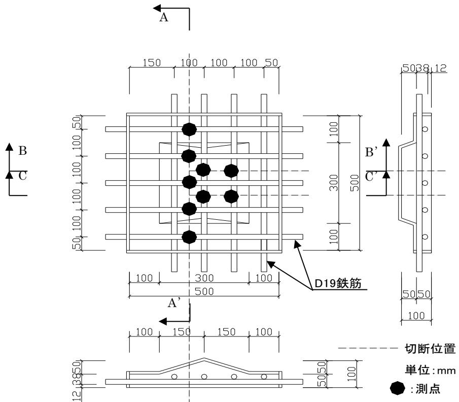
図1 鉄筋背面への充填性試験体
