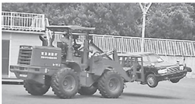
写真—3 ホイールローダーによる乗用車の移動作業状況
