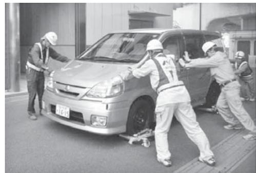
写真-2 車両移動用ジャッキの外観と移動作業状況
