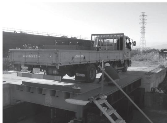
写真一 2 実トラック荷重試験の状況
