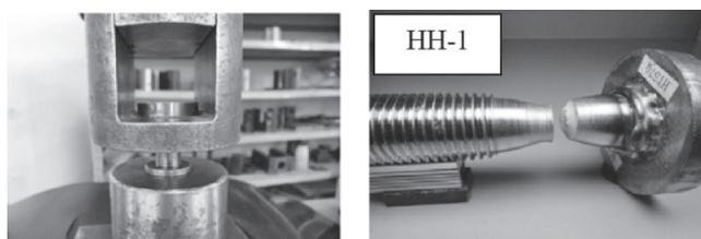
図-6 スタッドボルトの引張試験
