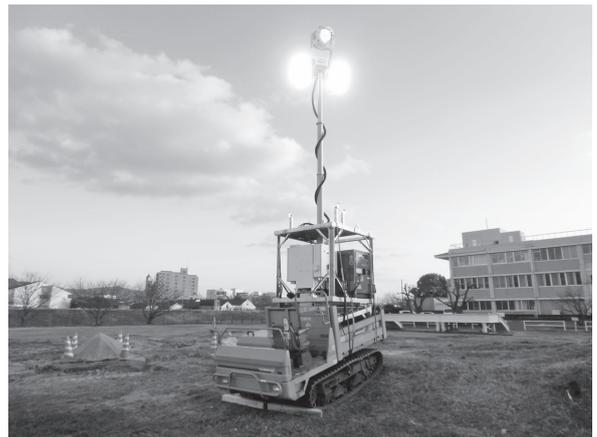
写真—6 不整地運搬車に搭載した災害対策用照明装置
