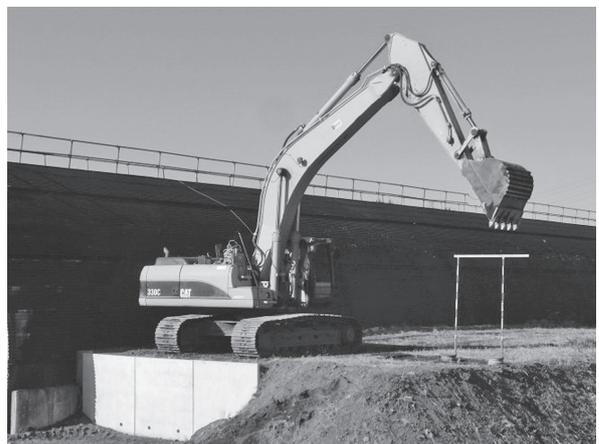
写真—4 エネルギー消費量確認試験の状況
