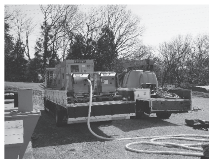
写真—1 電磁誘導加熱塗膜除去装置
