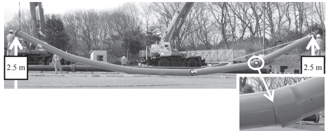
写真一 4 硬質塩化ビニル管の曲げ試験状況
