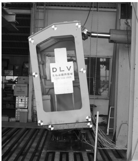
写真一 4 ROPS 試験状況
