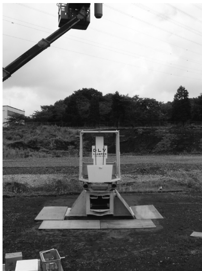
写真-2 FOPS (レベルII) の試験状況
