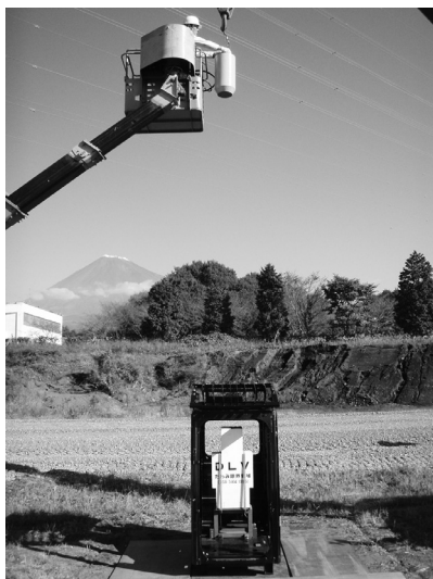
写真-3 トップガードの試験状況
