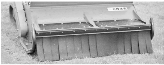
写真一 飛石防止装置
