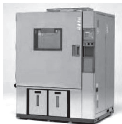
写真—4 恒温恒湿槽
