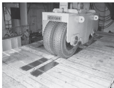
写真—1 移動荷重疲労試験状況
