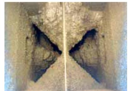
写真 - 3 CSGの混合機の一例と混合機へのCSG付着状況
